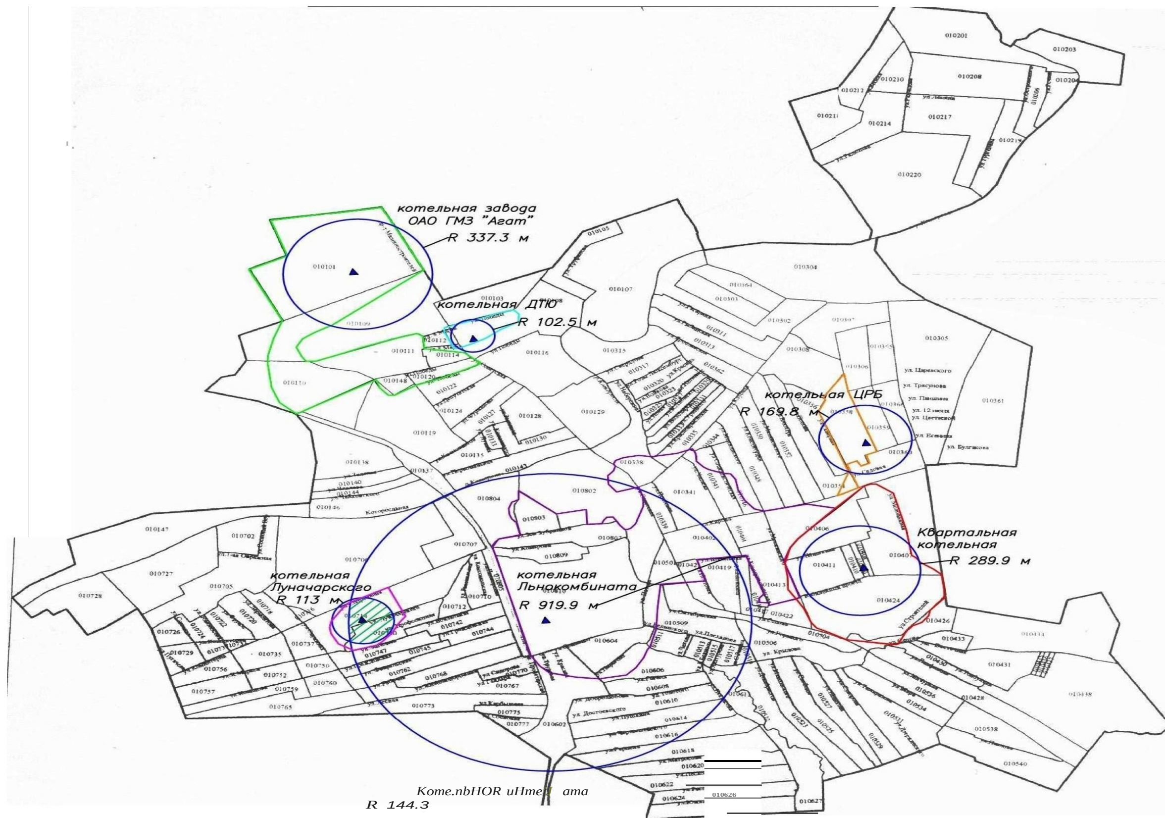
Рис.4. Схема перспективных зон действия источников тепловой энергии
