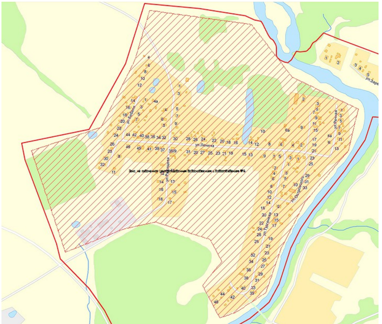
Рисунок 3.6 – Зона, не охваченная централизованным водоснабжением и водоотведением №6
