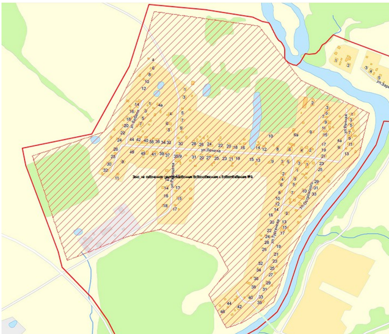
Рисунок 1.6 – Зона, не охваченная централизованным водоснабжением и водоотведением №6
