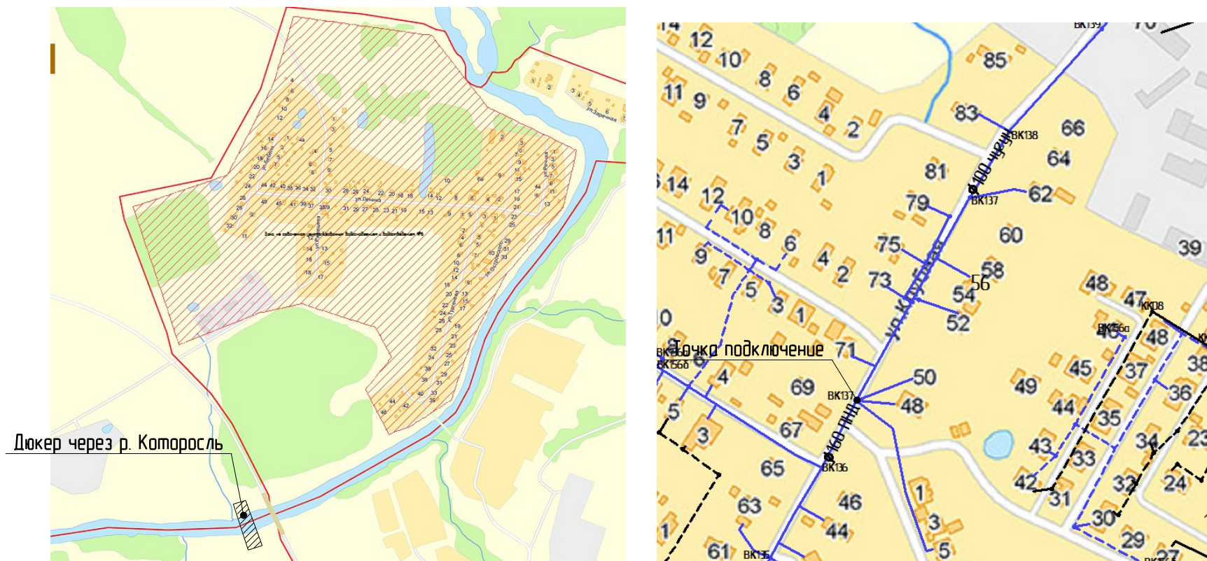
Рисунок 3.12 – Приблизительная схема подключения микрорайона к сетям водоснабжения
